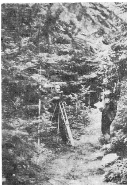
Rys. 13. Stanowisko tachimetru (droga leśna) w obrębie lasu o zwarcie 100%
