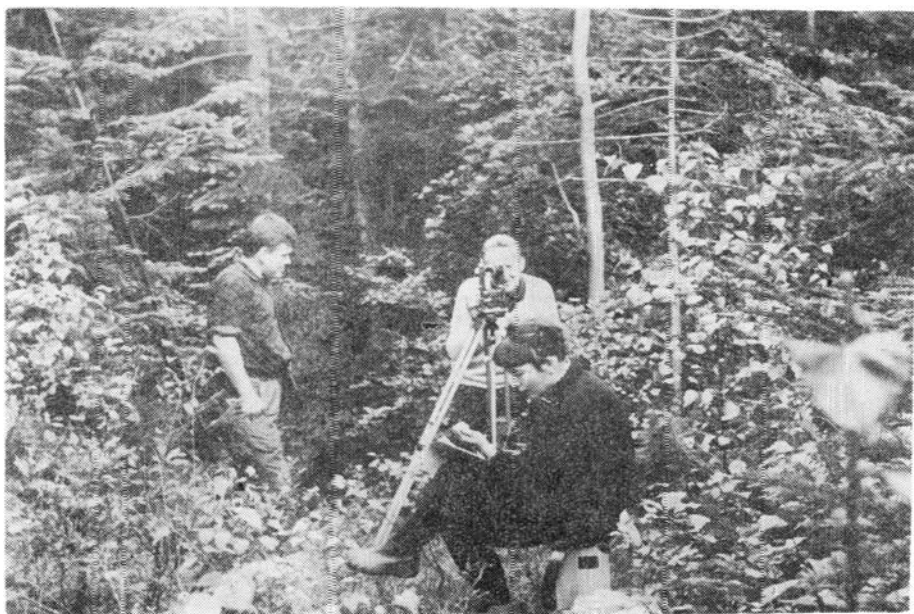
Rys. 6. Stanowisko tachinetru na pograniczu lasu o zwarcu 100% i 30%
